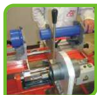
SALDATURA DI TESTA BUTT WELDING
